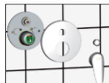
Наденьте накладку поверх картриджа и переключателя и завинтите в правильной позиции. Затем смонтируйте внешнюю декоративную накладку.
